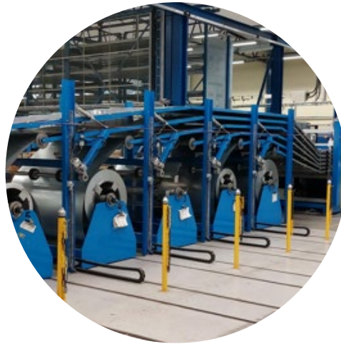
Coil-linjer för att minska plåtpill i flera anläggningar
